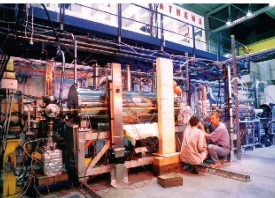
ATHERNA – одна из двух установок, на которых в CERN создается холодный антиводород.
